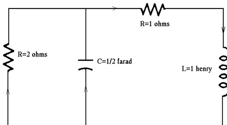
Plantear el sistema de ecuaciones diferenciales lineales que de él se obtiene. Determinar la corriente  $I$  que pasa por la inductancia y la caída del voltaje  $V$  a través del condensador suponiendo que  $I(0) = 1$  y  $V(0) = 2$ .
