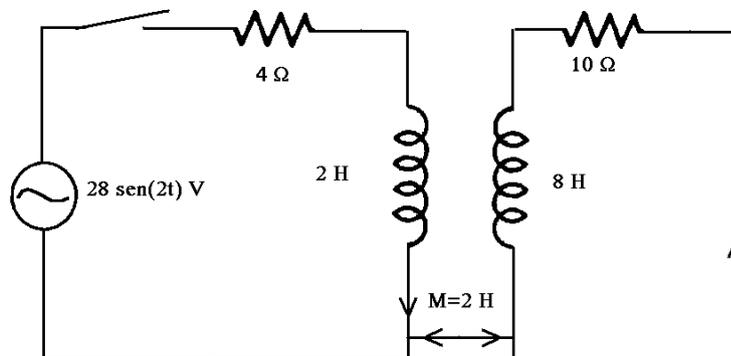
Si previo al cierre del interruptor, las corrientes en ambos circuitos son cero, determinar la corriente inducida  $i_2(t)$  en el segundo circuito en el tiempo  $t$ .
